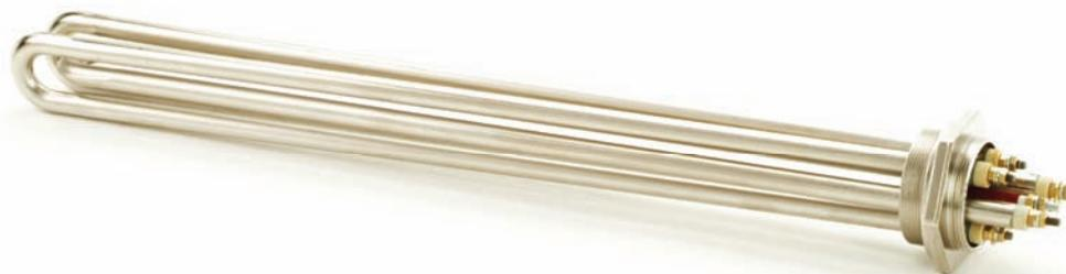
Tous les bouchons sont filetés côté connexions pour montage du boîtier de raccordement électrique. Ce boîtier est en aluminium avec degré de protection IP 55; il peut être avec ou sans thermostat de sécurité ou de régulation.
